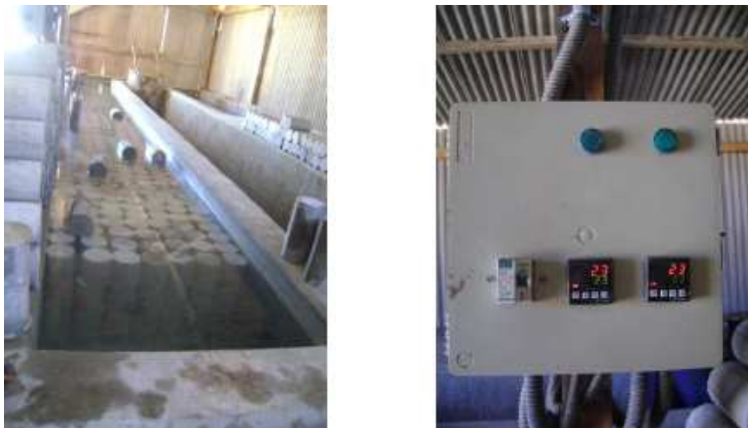
Figura 17 – Exemplo de tanque de cura de corpos-de-prova com controlador automático de temperatura (MAGALHÃES, 2009).
