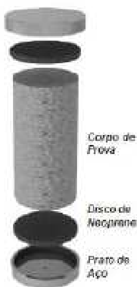
Figura 18 – Esquema de utilização de discos de neoprene para rompimento à compressão de corpo-de-prova (METHA e MONTEIRO, 2008).
