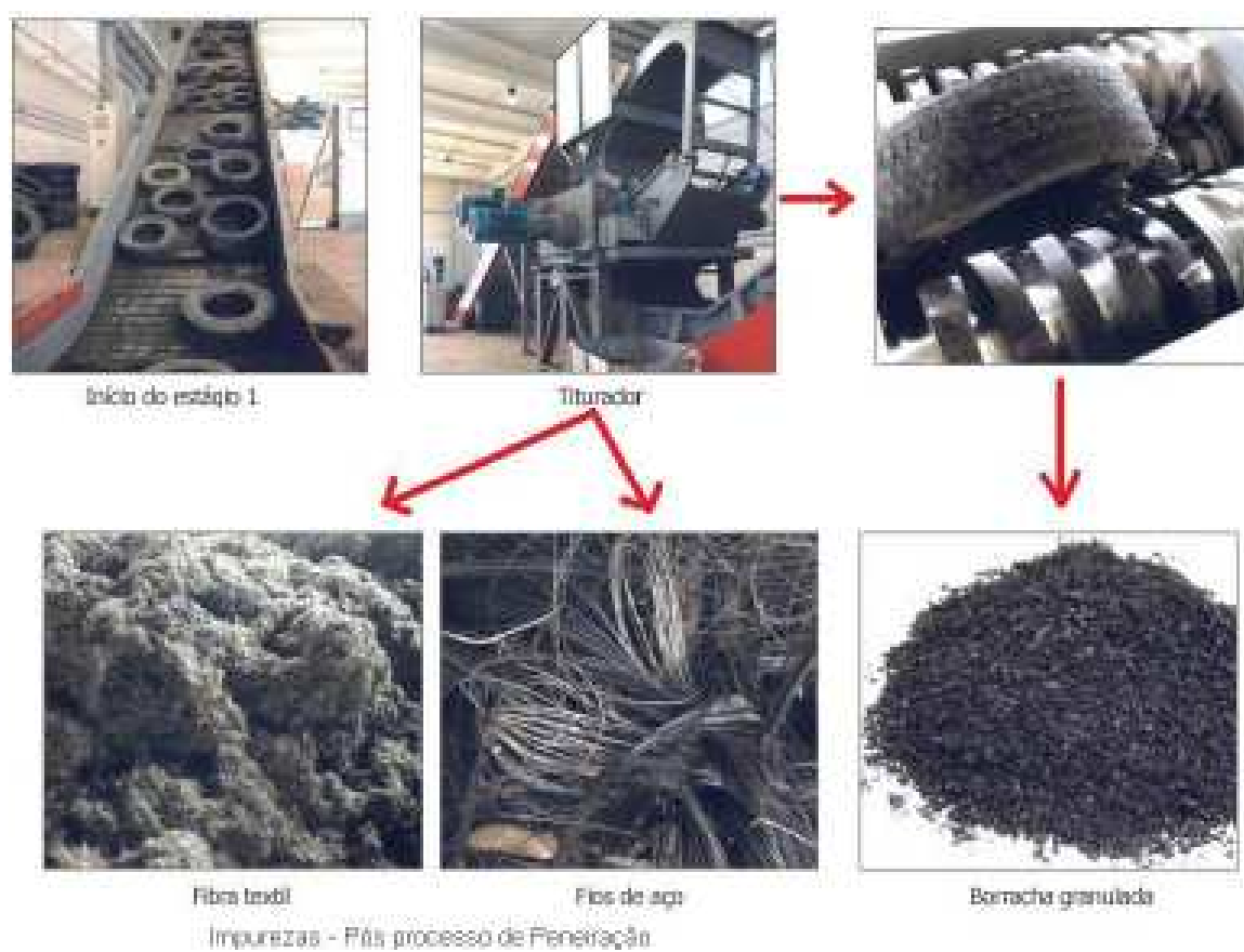
Figura 11 – Ciclo de moagem e separação da borracha de pneu (GRANZOTTO, 2010).
